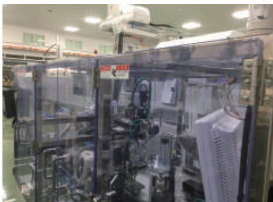
まず、全数自動検査ラインは写真のように成形機の真横に設置してあります。
