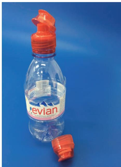
1つ目はねじ式キャップのいたずら防止機能です。これは一般的なペットボトルのねじ式キャップと同様で、キャップと一緒に形成されたバンドがあり、キャップのネジを回して開封するとバンドが切れるので、一度開栓されたことがわかるようになっています。
