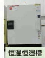
製品によっては保管環境・測定環境によって機能面で差が出てしまうことがあり、測定データを比較するためにも常に同じ温度条件で評価することが必要です。
