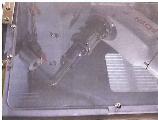
ロボットがワークを保持し研磨作業中
