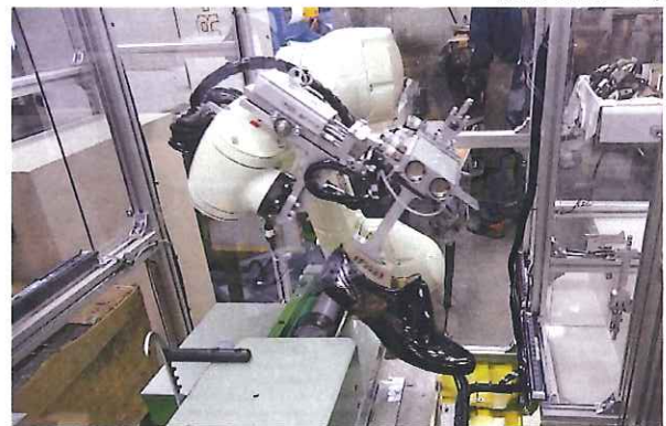
写真左上：中底及び甲革 写真左下：本底 写真右：刷毛を使った接着剤塗布
