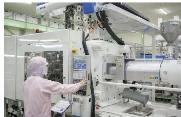
スパウトは両側面、キャップは天面・側面・内面をカメラ検査機で検査しており、検査結果情報をリアルタイムのデータとして活用することで、IoT技術を研ぎ澄まし、高品質な製品を提供いたします。
