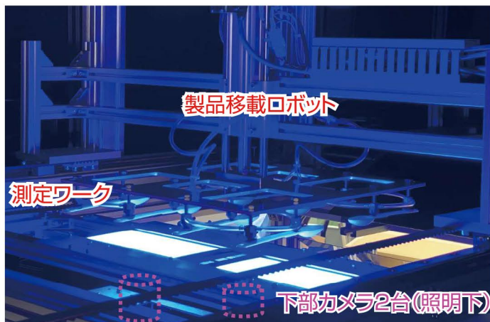
カメラ検査装置内部(下部カメラ検査)
