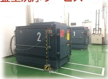
アスカカンパニーでは、生産終了後に樹脂が固化する事でメンテナンスが困難なホットランナー金型やミキシングノズル・ギャボンブなどの樹脂炭化異物やコンタミネーションを取り除くメンテナンスを提供しております。金型メンテナンスは10年以上の実績で提供しており、特長としては熱を利用した「金型にやさしい」炭化異物除去サービスを専用装置で行っています。また、熟練者によって、射出成形メーカーとしてのノウハウを活かしてメンテナンスを行っているため、安心して金型をお預けいただいております。
